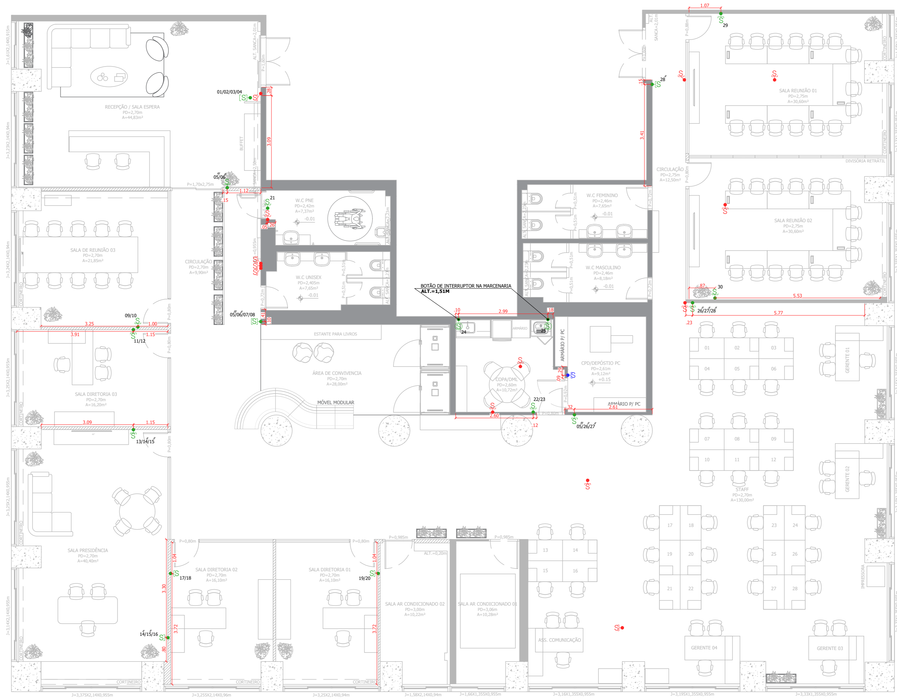
INTERRUPTORES ÁREA= 533,65m 2 esc 1:75
